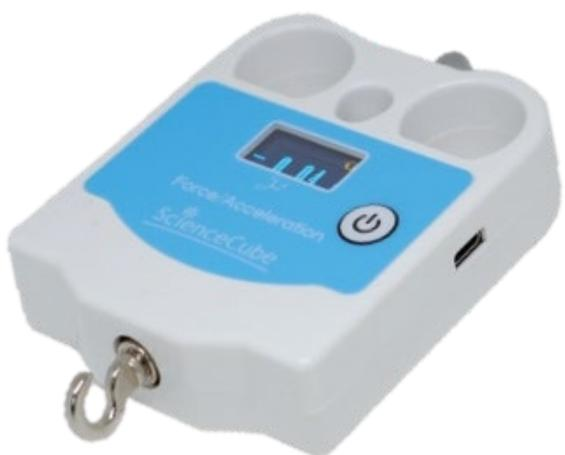
Il "Wireless Force Sensor" misura il peso e la forza. A differenza dei sensori di forza convenzionali, misura la forza e l'entità dell'accelerazione gravitazionale su ciascuno degli assi X, Y e Z. Può essere ampiamente utilizzato anche per la misurazione di accelerazione, urti, vibrazioni e inclinazione. Elenco degli esperimenti: attrito della legge di Hook, irrtazione e reazione galleggiabilità, impatto e slancio.
