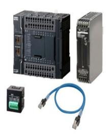
II Machine Controller NX1P2 è presente in questo kit con una CPU più performante (NX1P21040DT1) dotata di 24 ingressi digitali e 16 uscite digitali a bordo e che può gestire attraverso la rete EtherCAT 2 assi realizzabili con 2 servomotori serie 1S.
